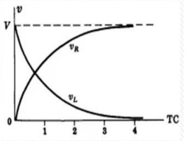
$$v_R + v_L = V(1 - e^{-(R/L)t}) + Ve^{-(R/L)t} = V$$
